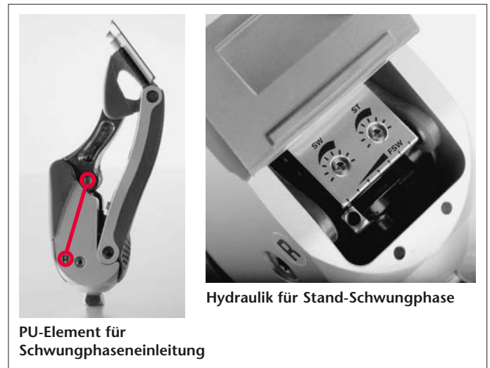
Abb. 6 Stand- und Schwungphasensteuerung des im Artikel beschriebenen Hüftgelenkes. Hydraulik für Stand- (ST) und Schwungphasenwiderstände (FSW, SW), Polyurethan-Elemente (PU) zur Unterstützung der Schwungphaseneinleitung.
