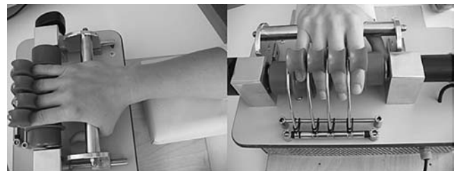
Abb. 5 Fingertrainer Reha-Digit. Das Gerät bewegt die plegischen Finger mithilfe einer Nockenwelle, zusätzlich erfolgt eine sensorische Stimulation sowie eine Vibration der Fingerbeeren.
