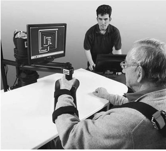
Abb. 3 MIT-Manus zwecks unilateraler Schulter- Ellenbogen-Bewegung in der Horizontalen.
