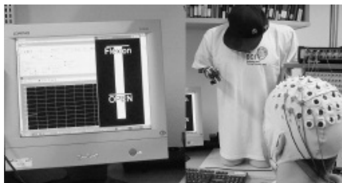
Abb. 3 Experimenteller Aufbau: Links sind der Feedback-Bildschirm und rechts der Roboter zu sehen sowie ein Proband und die Elektrodenmontage.
