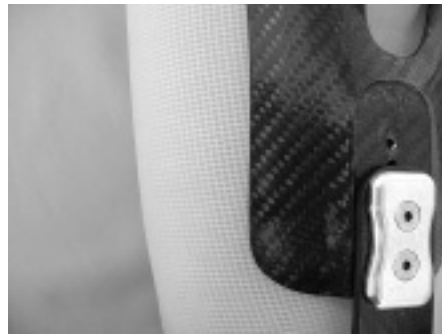
Abb. 5 Bidirektionales dehnsteifes Gewebe zur Verhinderung der zirkulären Aufweitung.
