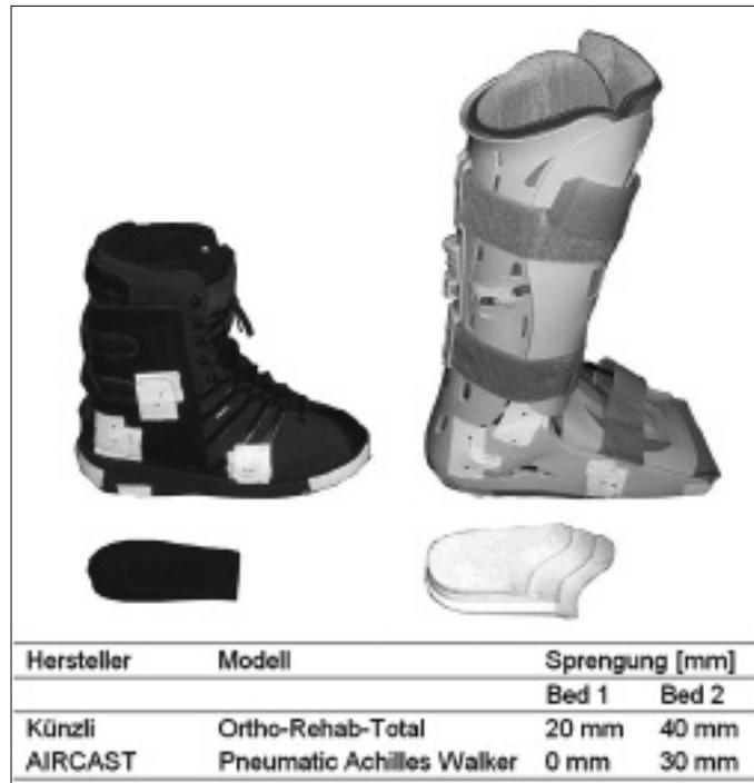
Abb. 1 Ansicht der Schuhmodelle mit Keilen. Links das Modell von Künzli, rechts das Modell von Aircast. Eine Auflistung der Schuhsprengeung befindet sich in der Tabelle.
