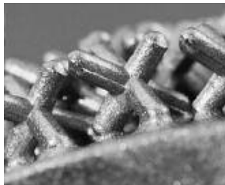
Abb. 3 Dreidimensionale Tripoden-Oberflächenstruktur von „Spongiosa Metall II“.
