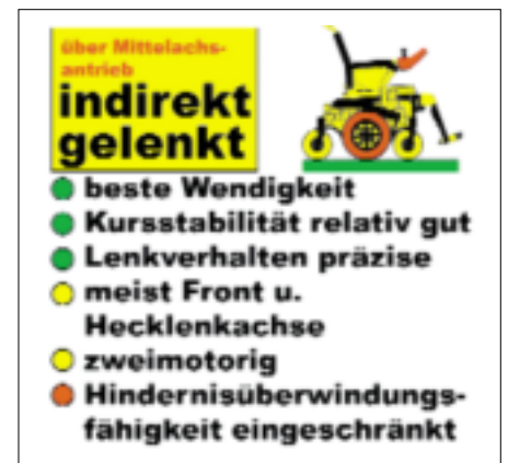
Abb. 10 Wesentliche Eigenschaften indirekt gelenkter Elektro-Rollstühle mit Mittelachsenantrieb.
