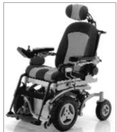
Abb. 6 Vorn angetriebener, hinten indirekt gelenkter Elektro-Rollstuhl, 2 x 300 W Nennleistung (Foto: Meyra/Ortopedia).
