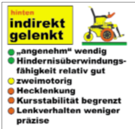
Abb. 7 Wesentliche Eigenschaften vorn angetriebener, hinten indirekt gelenkter Elektro-Rollstühle.
