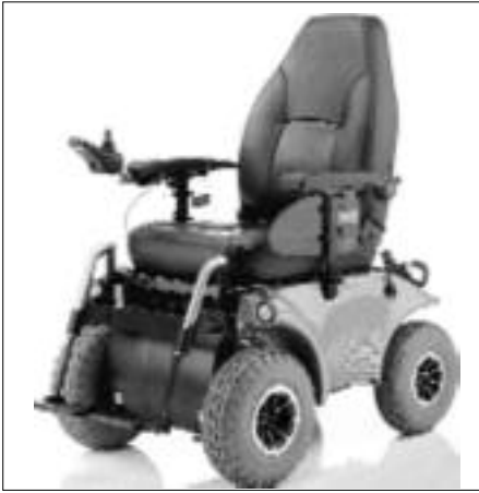
Abb. 11 Vorn angetriebener, hinten direkt gelenkter Rollstuhl, 750 W Nennleistung (Foto: Meyra/Ortopedia).
