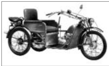
Abb. 1 Historischer, dreirädriger Rollstuhl mit Verbrennungsmotorantrieb, 2,75 PS Nennleistung.
