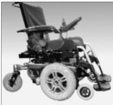
Abb. 8 Mittelachsenantrieb, hinten indirekt gelenkter, vorn un gelenkter Elektro-Rollstuhl, 2 x 300 W Nennleistung (Foto: Weege).
